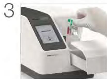
Coloque el cartucho de prueba en el analizador y cierre la tapa. El procesamiento empieza automáticamente.
