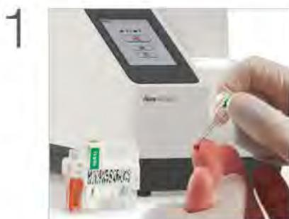
Obtenga la muestra con el dispositivo de muestra integrado.
